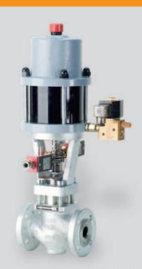
电动气动驱动,也可配置防爆功能 ② 法兰连接口径 DN 15 - DN 80 最大工作压力可达 40 bar,介质温度 140 °C / 200 °C
