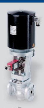
电磁驱动,也可配置防爆功能 ② 螺纹连接口径 G 1/4 - G 2 法兰连接口径 DN 15 - DN 150 最大工作压力可达 40 bar,介质温度 140 °C / 200 °C
