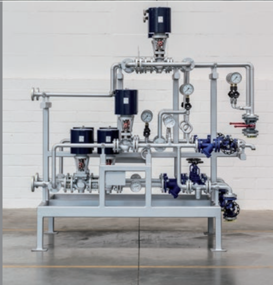
Armaturenstation für eine Schweröl-Feuerungsanlage mit Zerstäuberluft-Strang und Ausblasedampf, kompletter Instrumentierung sowie Auffangwanne.
