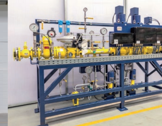
Vielseitig: Haupt-Regelstrecke inkl. Vorkammer-Regelstrecke für Gasmotor.
