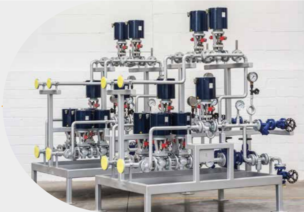
Armaturenstation für Großkesselanlage
